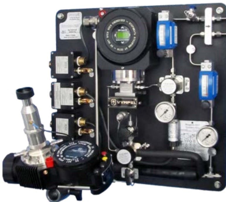
Рисунок П.2 — СПГ «Model-003» с измерителем «Hygrovision-mini»
